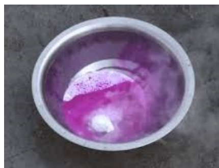
Fig. 5.3. Natriumi reagon me ujin dhe fitohet hidroksid natriumi.
