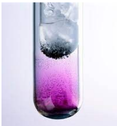
Fig. 2.26. Në temperaturën e dhomës, jodi është substancë e ngurtë me ngjyrë gri. Ai sublimon në avuj ngjyrë vjollce, e cila në prekje me një lëndë të ftohtë kalojnë në gjendje të ngurtë. Kjo veti e jodit mund të shërben për ndarjen e saj nga përzierjet.
