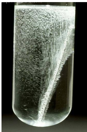
Fig. 5.16. Kur zinku reagon me HCl, lirohen fluska të hidrogjenit të gaztë.
