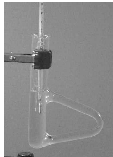
Fig. 2.9. Temperatura e shkrirja së substancave të ngurta mund të përcaktohet me të ashtuquajturën “aparati i Tileov-it”.
