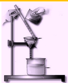
Fig 2.28. Pajisjet e filtrimit. Nëpër letrën filtruese kalon lëngun e pastër gjë, a në letër filtri mbetet substanca e ngurtë.
