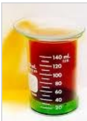
Fig. 5.17. Gjatë reagimit të metaleve me acid nitrik të përqëndruar lirohet \text{NO}_2 , i cili është gaz ngjyrë e kuqe-gafeje.
