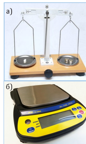
Figura 1.8. a) Peshorja teknike; b) peshorja digjitale.
